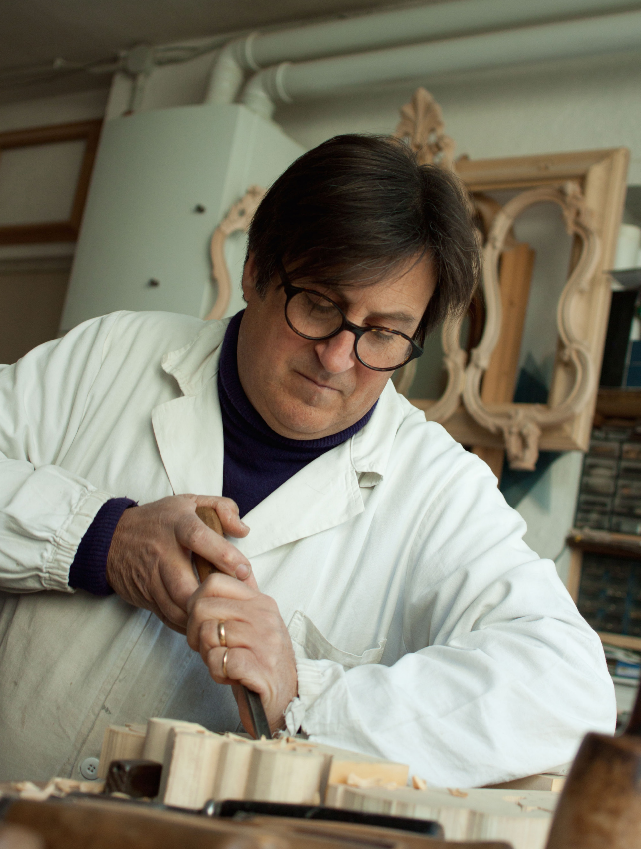
Figura 2 – La percussione appoggiata, postura corporea e impugnatura delle mani sulla sgorbia. Lentate sul Seveso (MB), 2012. Scatto Roberto Bassignana. Progetto Sa. Te. Val – Università degli Studi di Milano-Bicocca. DIRITTI RISERVATI.
